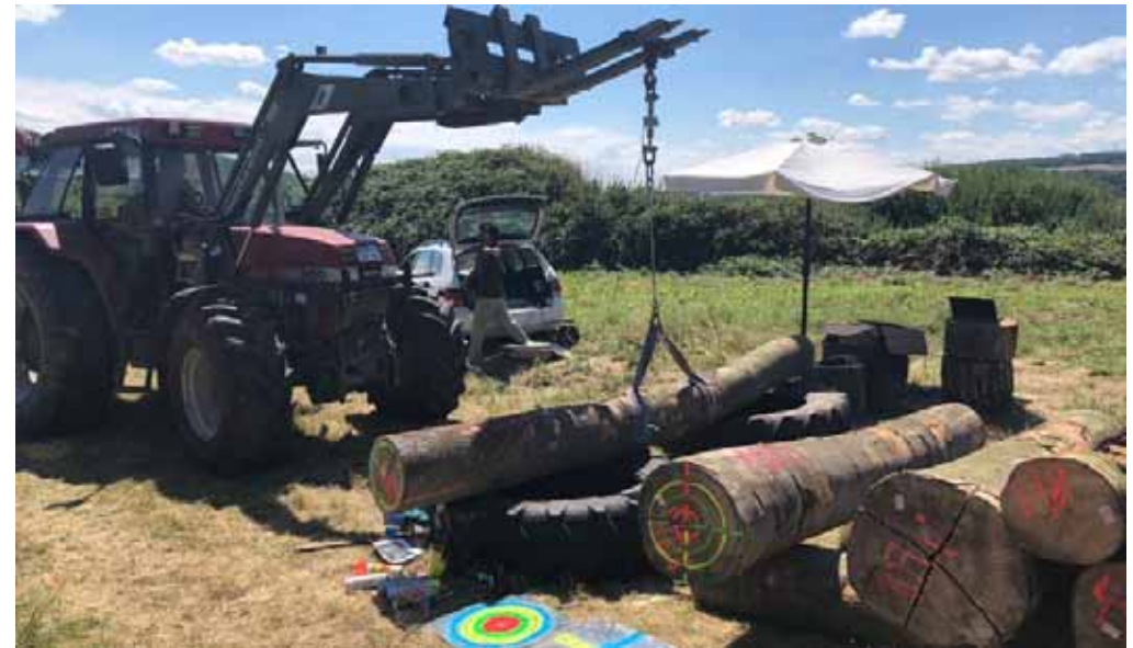
Misurazione del Modulo di Elasticità die tronchi.
